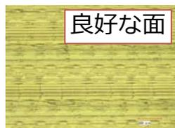
肉盛材は溶製材切削時よりも工具の損傷が大きいですが、焼鈍材よりも良好な加工面を得られることが分かった。
