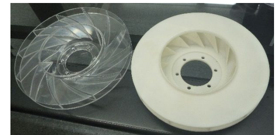
大型一体型ターボファンの試作造形
