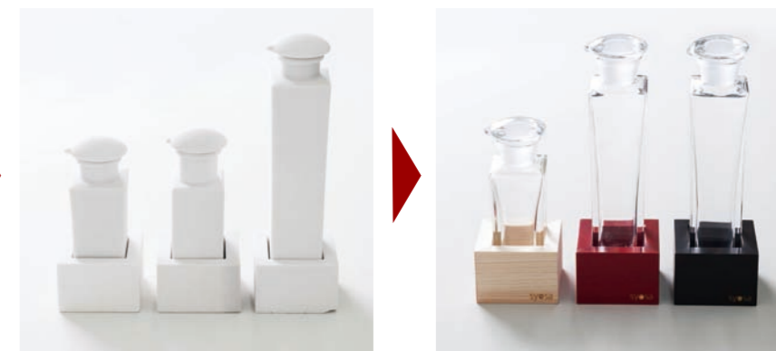
データ上でのデザイン提案(写真左)からAMでの試作(写真中央)を経て、製品化(写真右)が進められた。
