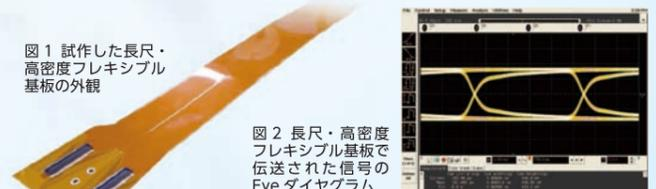
図1 試作した長尺・高密度フレキシブル基板の外観
