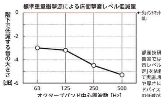
都産技研の結合残響室では、「床衝撃音レベル低減量測定」を依頼試験として実施。積層の順番や厚さに関するアドバイスを、音の低減が実現した。
