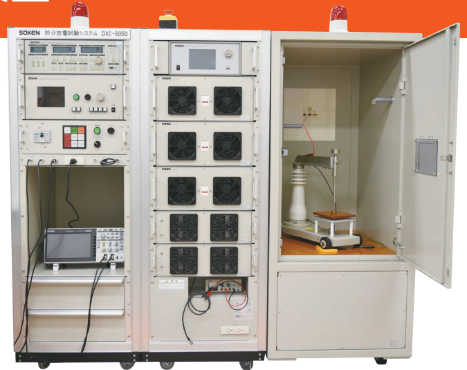
装置外観 左・中央) 測定器・制御部 右) シールドボックス測定部
