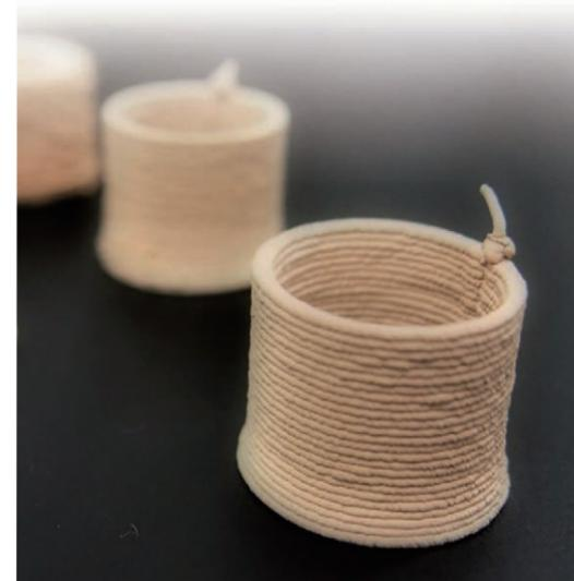
複合材料でした。研究は「AM (3Dプリンター)\*の素材として応用できる木粉ベースの複合材料の開発」として平成26年秋にスタート。約3年の期間を経て、木粉と角又糊（海藻糊）を用いた複合材料を開発しました（特許出願中）。100%天然由来の材料であり、樹脂に比べ原料コストも抑えられます。
