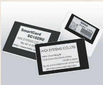
(左) 電子ペーパーと、無線で情報のやりとりを行うRFIDを組み合わせた「見えるRFID」の「スマートカード」。内容物の表示はスマートフォンで100万回以上書き換え可能。 (右) 「プロジェクションピッキングシステム®」を導入した調剤薬局では、バーコードをスキャンすると必要な薬剤のボックスが光り、取り間違いを防止。この技術は、2018年に「九都県市のきらりと光る産業技術」の東京都代表に選ばれた。
