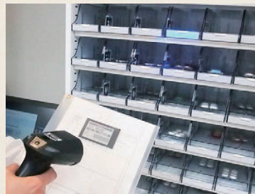
(左) 電子ペーパーと、無線で情報のやりとりを行うRFIDを組み合わせた「見えるRFID」の「スマートカード」。内容物の表示はスマートフォンで100万回以上書き換え可能。 (右) 「プロジェクションピッキングシステム®」を導入した調剤薬局では、バーコードをスキャンすると必要な薬剤のボックスが光り、取り間違いを防止。この技術は、2018年に「九都県市のきらりと光る産業技術」の東京都代表に選ばれた。
