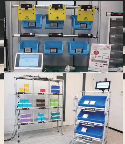
(上) 組み立て作業時に、適切な部品を取り出すための支援システム。 (下) 物流施設では、何をピッキングしてどの箱に入れるかまで全自動で指令が出される。
