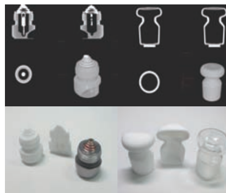
図5. 部品のCT像とRP造形品
