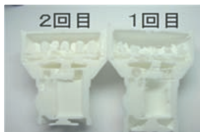
図4. 懐中電灯のCT像とRP造形品
