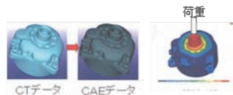
図6. CT像の3D-CAD化とCAEへの応用例
