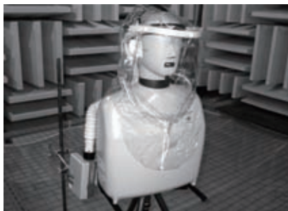
図1. 医療現場で使用されているPAPRと無響室での騒音及び音声測定の様子
