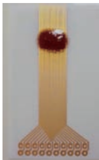
図5. シート抵抗を測定した治具
