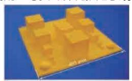
図1. 吹付ガン式植毛装置による植毛品 (長谷川 他, *J. Jpn. Soc. Colour Mater.*, Vol. 90, No. 1, pp. 11 (2017) の Fig. 5 引用)
