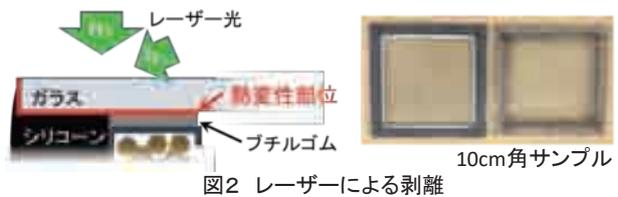
図2 レーザーによる剥離
