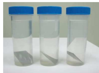
図1 溶出試験に用いた容器と試験片
