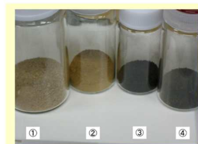
写真 調製後の落ち葉試料外観 ①アルカリ処理 ②未処理 ③硫酸処理 ④硫酸+アルカリ処理
