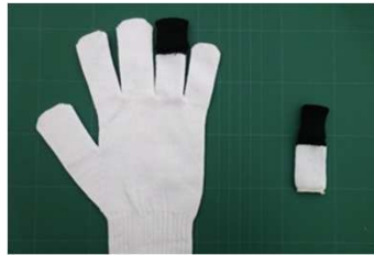
図1. 導電繊維（濃色部）を編みこんだ手袋と指サック
