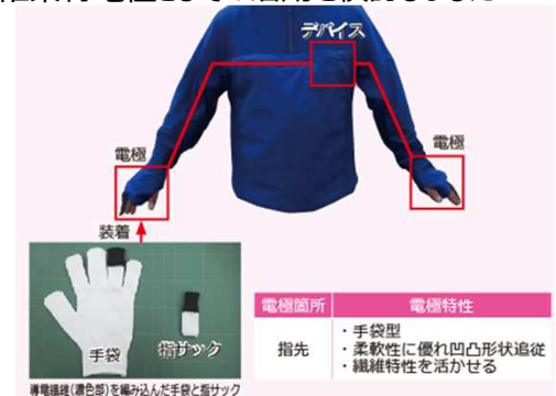
図2. 生体信号解析デバイス付属した試作ウェア
