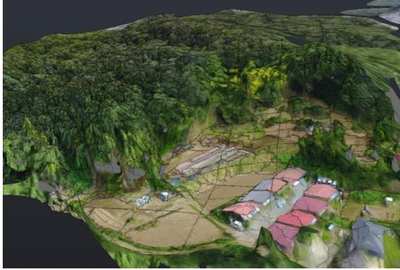
UAV（ドローン）による高精細な航空写真から、短時間で地形の3Dデータを作成
