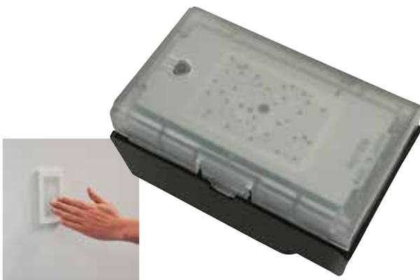
**製品の概要** 静電容量技術を使った非接触照明スイッチ。4cm 程度離れたところから手をかざすとオンオフ。触れないので衛生的
