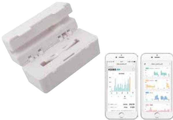
**製品の概要** 電源コードにクリップするだけで個別機器の消費電力を簡易的に計測できるデバイス。データはスマートフォン等で簡単に見ることができる
