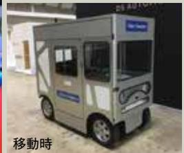
「JT1011型」は、ミニカー規格のEV。全長2,100mm×全幅1,120mm×全高1,980mm、車両重量410kgの軽量かつコンパクトなボディを持つ、新たな発想のマイクロEVです。業務用エレベーターに乗るサイズなので、商業施設等の建物の屋上やフロアへそのまま移動が可能、会場(設置場所)に着いたらシェル状の外壁がスライドして店舗や事務所として運用できる意欲的なモデルとなっています。
