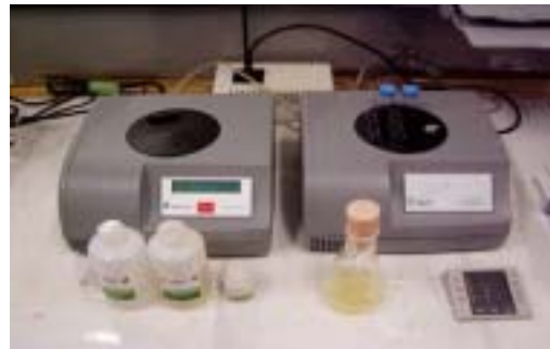
図2 ルミノメータ（左）と冷却ユニット（右）
