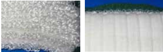
図3．接結系の飛び出し 図4．飛び出し防止対策後
