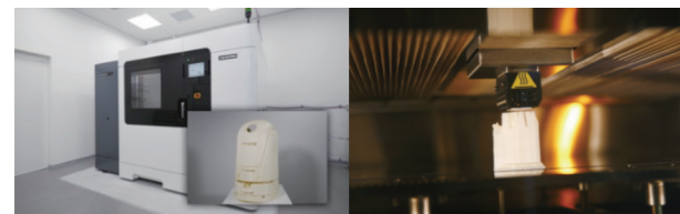
超大型樹脂溶融 AM (3D プリンタ) 金型を必要とせず、大型のロボット部品を作製できます。 最大造形サイズ：約 914 × 610 × 914 mm 材料樹脂：ABS・ASA
