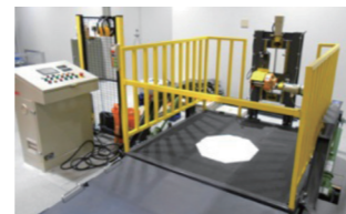
静的安定性試験機 移動ロボットなどを傾斜させたときの、ロボットの滑り落ちや転倒現象を確認する装置です。
