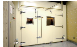
複合環境振動試験装置 温度や湿度、振動を模擬した環境下でのロボットの機能評価が可能です。
