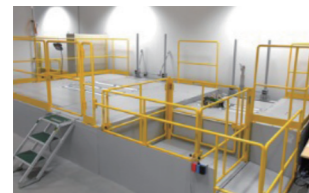
ドラム型走行耐久性試験機 突起が付いたローラーで車輪型ロボット等のタイヤに衝撃を与え続けることで、駆動部の耐久性を評価する試験機です。
