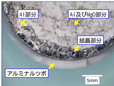
図4 アルミナルツボ中の析出結晶
