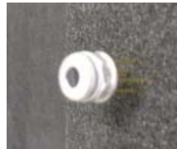
図7. サーモパイル
