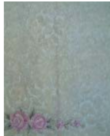
写真2 ポリエステル繊維の再汚染で生じた変色
