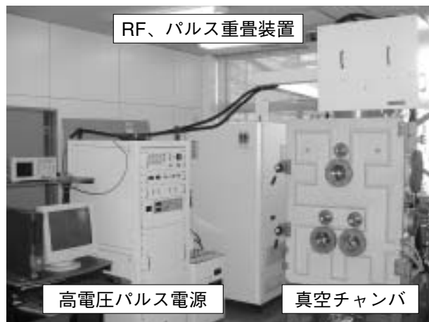
写真1 試作した高効率プラズマイオン注入装置
