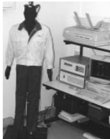
写真3 サーマルマネキンの測定機器一式 衣服を着せて衣服の保温性を測定します。
