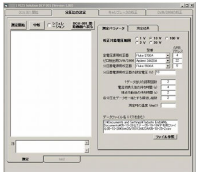
図6 電圧分圧器の分圧比の校正画面
