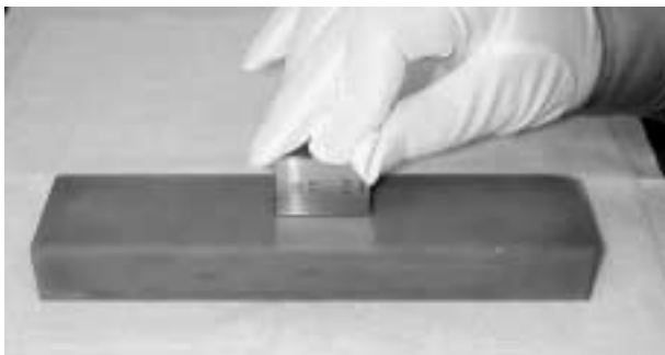
写真5 面のカエリの落とし方
