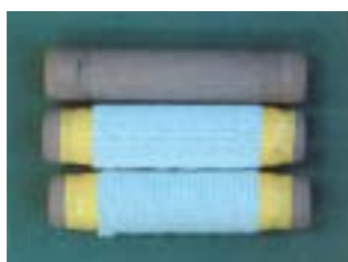
図5 ピリング試験の試料
