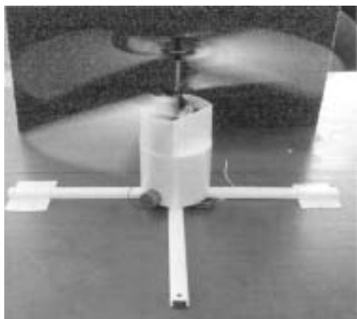
写真1 ケーブルレス・ヘリコプター型飛翔体の回転試験
