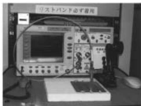
写真1 タイムドメイン測定装置での測定例
