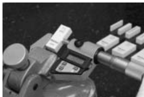
写真3 マイクロメータの器差測定
