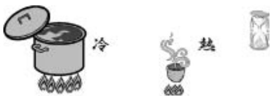
図5 小さな容器は熱応答が速い
