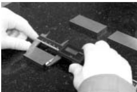
写真2 ノギスの器差測定
