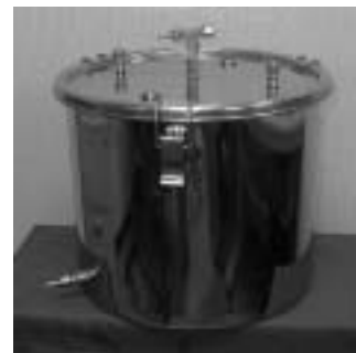
図2 20L小形チャンバー チャンバー上部の出口に捕集管を付けて測定します。
