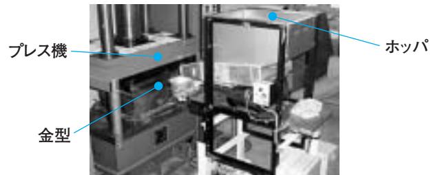
図3 原料供給装置
