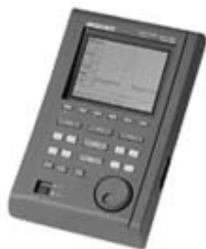
写真1 ハンディー型スペクトラムアナライザー
