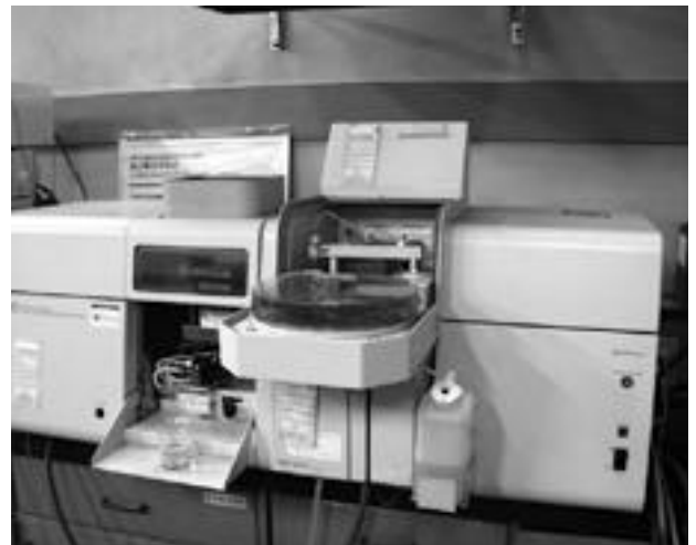
写真2 電気加熱方式原子吸光分析装置 溶出液に溶け出した鉛やカドミウムなどを分析します。
