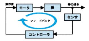
図2 倒立振子制御のブロック線図
