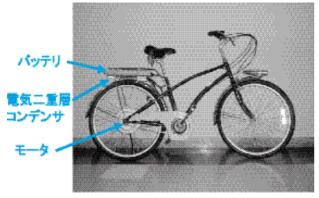
図4 電動アシスト自転車への応用
