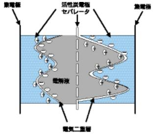
図 2 電気二重層コンデンサのモデル(原理) 集電極、活性炭電極、電解液、セパレータで構成されています。活性炭電極と電解液の間に電気二重層ができます。
