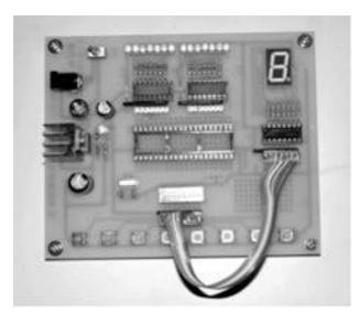
写真 1 PICマイコン評価用基板(当会製作) PIC (Perpheral Interface Controller): 小型で外付け部品が少ないオールインワンのマイコンチップです。
