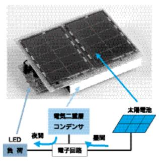
図5 太陽電池を用いた小電力供給システム 昼間、太陽電池を用いて、電気二重層コンデンサに充電し、 夜間に電気二重層コンデンサに蓄積した電力でLEDを点灯さ せるものです。
