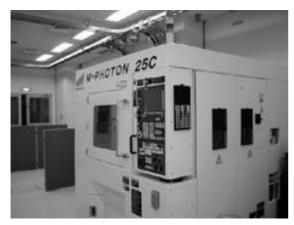
写真1 金属光造形複合加工システム
