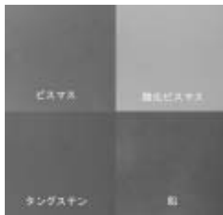
図4 高比重ゴムを用いた放射線遮へいシート 空港の手荷物検査等、X線やガンマ線の放射線の遮へい材として期待されます。
