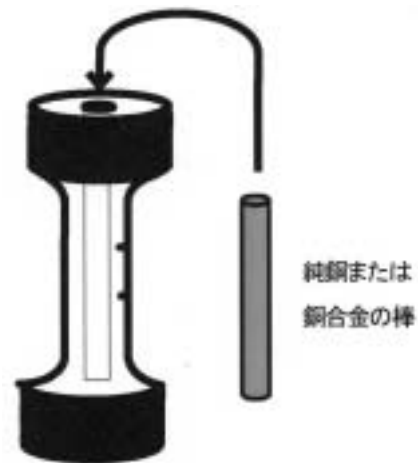
図1 高温時の加工性を調べるための鋼試験片 高温時の圧延加工性を直線方向の引張特性でもって評価する
