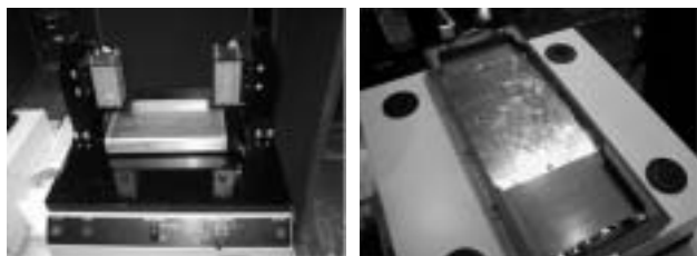
写真1. 微小部品整列機 (左) と整列パレット
