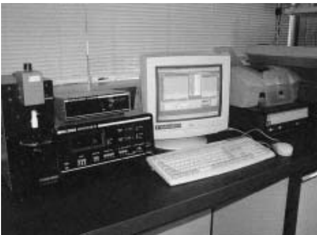
図1 クリープメーター装置外観 (レオナーRE-3305：株式会社山電)
