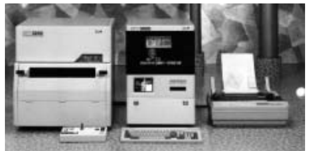
写真1 蛍光X線膜厚計（SFT3200）
