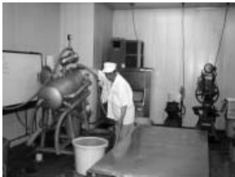
東蒲組合のすり身加工所(左側の機械が減圧晒し機)
