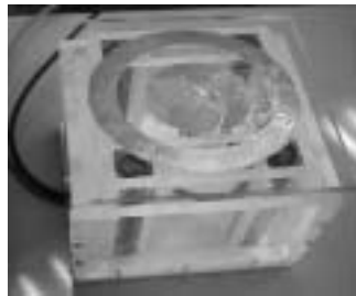
写真1 導電性計測アタッチメント 上面を生地に押し当て計測する。
