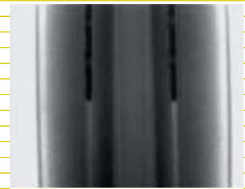
アルミ電解コンデンサの透視画像 (管電圧70kV)
