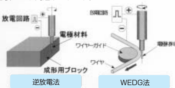
図1 逆放電法とWEDG法
