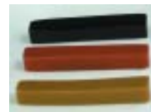
写真4 着色化した粉末べっ甲基材 上：半透明 右：不透明
