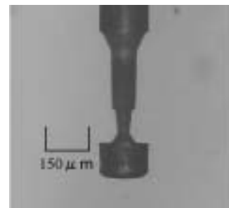
(電圧: 110\text{V} 、コンデンサー容量: 100\text{pF} 、送り速度 2\mu\text{m/s} ) 図6 段付軸 (タングステン) 従来では成形できなかった段付軸成形例です。
