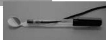
図7 カメラ先端部分にミラーを取り付けた例
