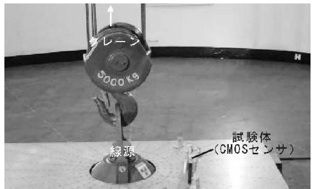
写真5 照射室(II)での耐放射線試験の様子
