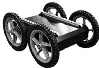
写真1 ロボット開発支援プラットフォーム
