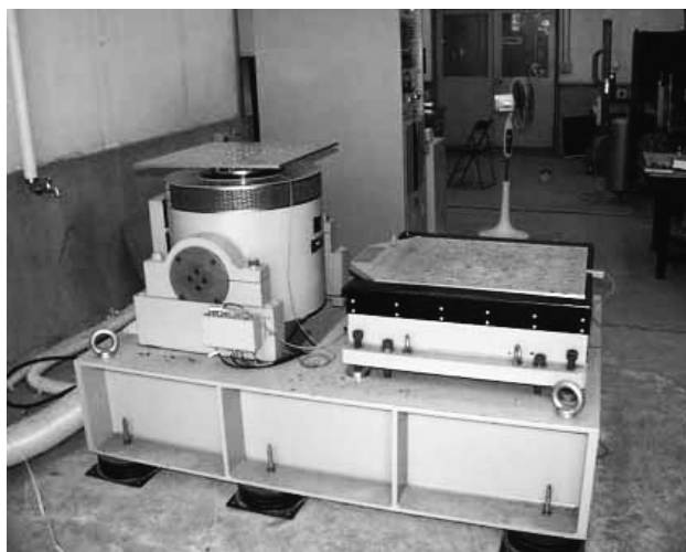
写真 振動試験機
