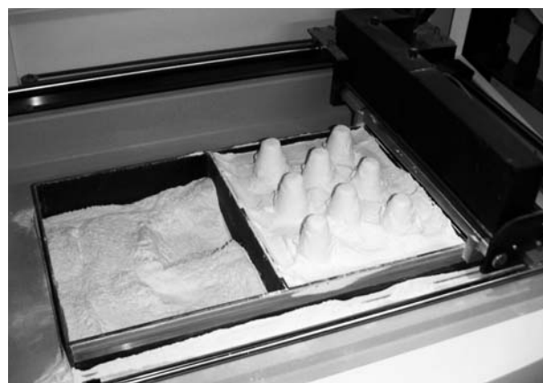
図4 出来上がった造形物の取り出しの様子
