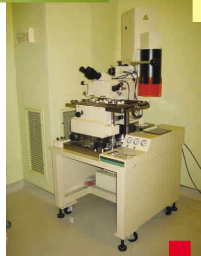
写真5 紫外線露光装置 紫外線感光樹脂を用いたミクロン単位のパターン複製を行う装置
