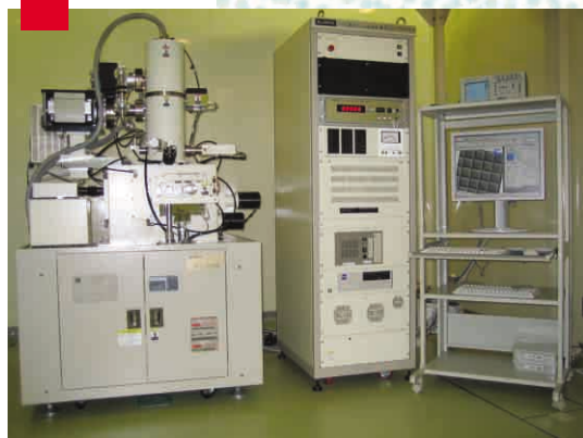
写真3 電子線描画装置 加速電圧50kVの電子線を用いた最少線幅10nmのパターニングが可能
