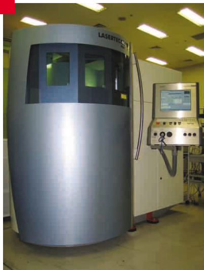
写真1 レーザー型彫り装置 ビーム径40 \mu mのYAGレーザーを用いて 型彫り加工する装置
