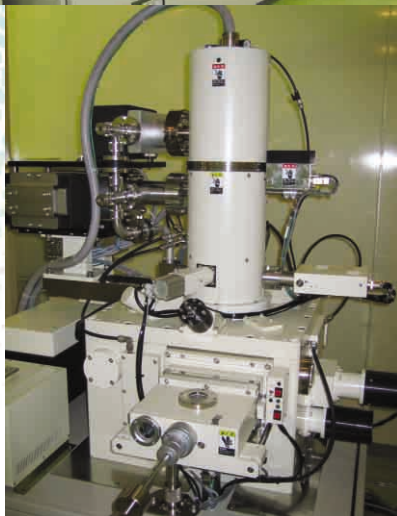
写真4 電子線描画装置の鏡筒・真空室部分 加速電圧50kVの電子線を用いた最少線幅10nmのパターニングが可能
