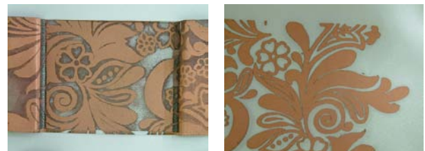
図2. パラジウム付与布への無電解めっき
