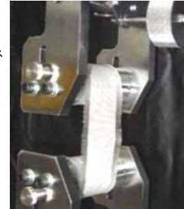
図 2.巻き込み型引張試験治具
