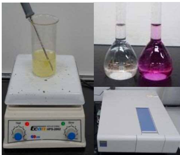
図1. 六価クロム抽出工程（左）、ジフェニルカルバジドによる呈色（右上）、吸光光度計による測定（右下）
