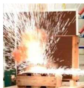
金属の溶融 (雷インパルス耐電流試験)
