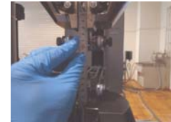
Ti合金ボルトの引張試験の様子
