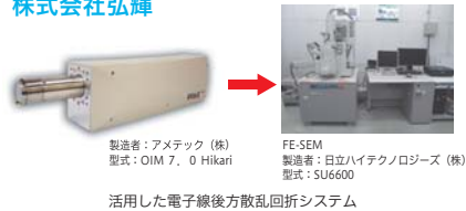
活用した電子線後方散乱回折システム
