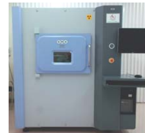
使用機器：マイクロフォーカスX線透視装置 平成26年度 公益財団法人JKA 機械工業育成機器整備補助事業で導入
