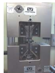
図1 アライメント調整機能付引張試験チャック
