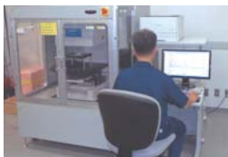
X線分析顕微鏡による マグネシウムダイカスト鑄造試験品の分析
