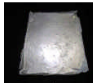
図2 金属光沢アルミナ膜の写真。中央の明るい箇所は光源の LED ランプの反射光である。
