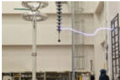
建物への放電 (雷インパルス耐電圧試験)
