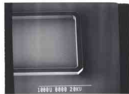
図2 シリコン基板上に形成したSU-8モールド
