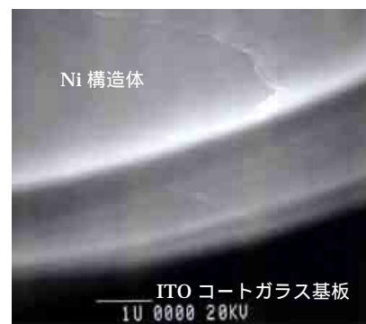
図3 Ni電析によって形成したモールド
