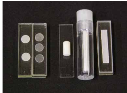
図1.今回試作したアラニン線量計素子(1,2)及び国内で開発されたアラニン線量計素子(3~5)を円形に加工した素子(F-AL: 6mm×220µm)コーティングタイプ素子(C-AL: 6mm×30,50,100µm)日本アイソトープ協会ロッド状素子(5mm×10mm)、日立電線ロッド状素子(3mm×30mm)日立電線フィルム状素子(F-AL:4mm×30mm×220µm)
