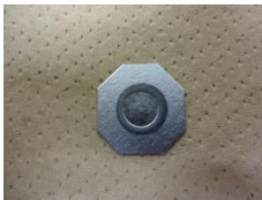
図1. タングステンGD-MS分析後の試料外観 (板材中心部の8 mm径の放電痕が分析領域)
